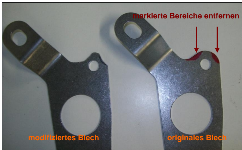
Fig. 2 - Modifikation des Befestigungsbleches
