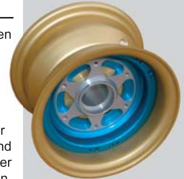
Sicherheits-Hauptfahrwerks-Alufelge mit Bremsankerplatte und Radnabe.
