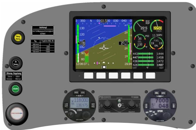
Die Primär-Fluginstrumentierung, als auch die Anzeige der Motorparameter erfolgen über das DYNON FlightDEK D-180. Hierbei handelt es sich um ein hochintegriertes Anzeigesystem, es vereint das „Electronic Flight Information Display“ und das „Multi Function Display“, was bedeutet, es finden sich hier alle herkömmlichen primären und sekundären Fluginstrumente, Navigationsinstrumente und die Motorinstrumente auf einem Bildschirm wieder. Im FlightDEK D-180 sind folgende Funktionen integriert:
