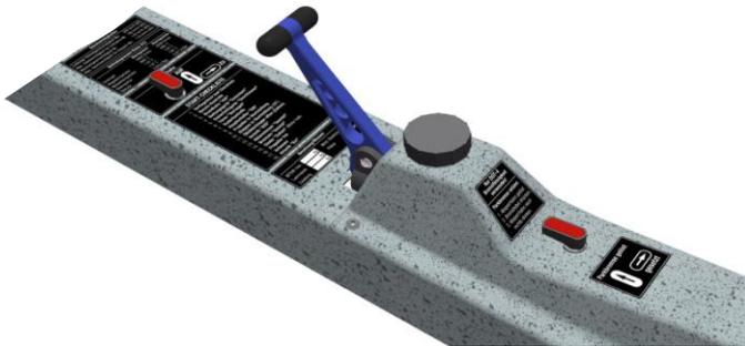
Alle Bedienelemente tragen eindeutige Beschriftungen. Zusätzlich finden sich hier die wichtigsten Aufkleber mit Grenzwerten für den sicheren Betrieb des Flugzeuges, einer Startcheckliste und den Massenangaben.
