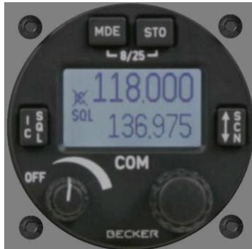
Der VHF Transceiver kann mit Standard oder dynamischen Mikrofonen verwendet werden.
