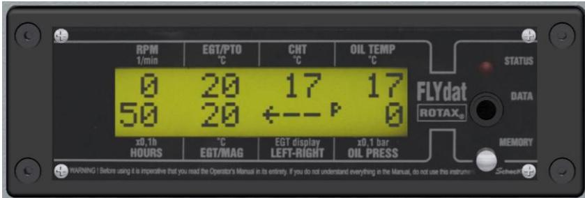
Bei Annäherung an einen Grenzwert beginnt die betroffene Anzeige im Display zu blinken. Wird ein Grenzwert überschritten, findet eine Alarmierung durch eine rote Status-Leuchte statt und der Wert wird im Datenspeicher des FLYdat abgelegt. Durch die mitgelieferte PC-Software können diese Werte jederzeit ausgelesen werden.
