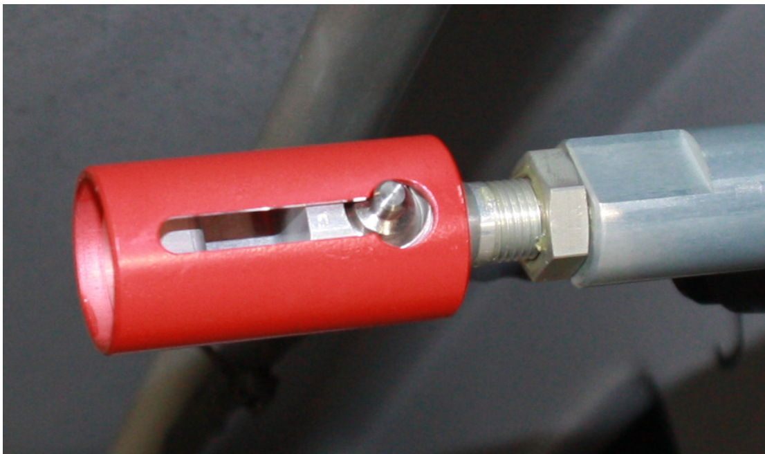
Fig. 5b – unsicherer Schnellverschluss, falsche Position des Schnellverschlusses
