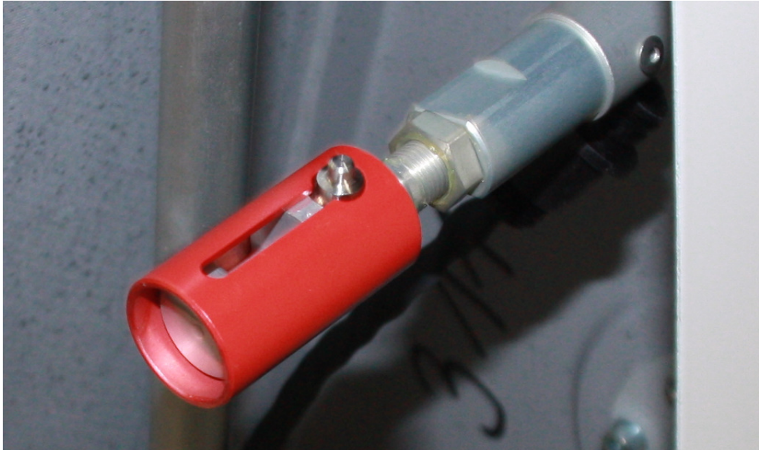
Fig. 5a – gesicherter Schnellverschluss, korrekte Position des Sicherungsstiftes
