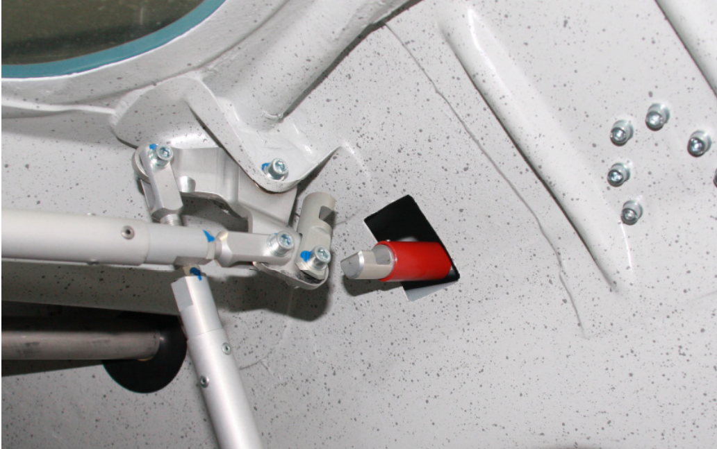
Fig. 1a – linker QR Schnellverschluss, nicht verbunden und gesichert
