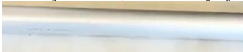
typischer Abrieb bei ca. 500h TTAF
