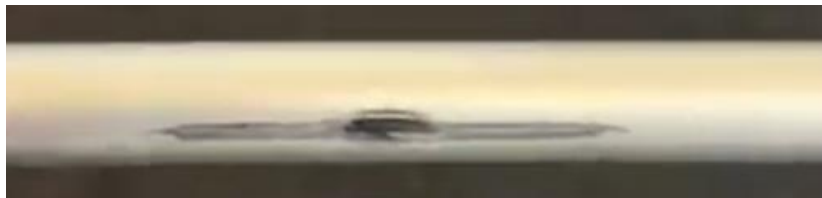
starker Abrieb nach ca. 5.000h TTAF, Messung erforderlich
